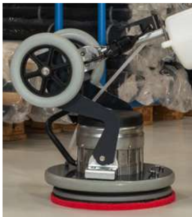
Uchylny dyszel zwiększający siłę nacisku.
